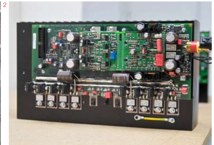
1 Bernd Sander 近年來對於交換式放大器下了很多工夫研究，他手中的就是一塊自己手焊的交換式放大器線路板。交換式放大器能夠達到比現行 Audionet 擴大機更好的效果嗎？「不行，他們對於喇叭的變化太敏感了，我們無法確保它們接上任何喇叭都會有相同的效果。」2 從這塊後級功率輸出的線路板就可以清楚看到，右邊架在線路板上的兩塊就是 ULA 線路，上面有密密麻麻的表面附著元件。底下的則是功率晶體，每顆功率晶體都有距離極近的獨立供電，這些都可以確保 Audionet 的擴大機有著最高的速度。
