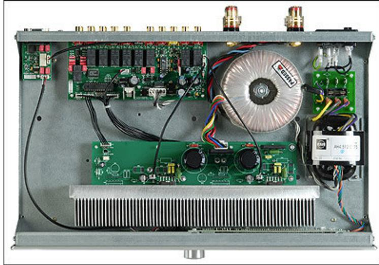
型變壓器，可自動濾除大量雜訊；而功率放大級則使用具有高頻寬特性的環型變壓器，使整體電源處理達到的最佳化。未來 HD Micromega 還將推出選購配件 iDok 連結座，可透過 IA-60 背面的 DB9 端子做連結，不僅能提供 iPod 或 iPhone 充電，也能使用選購的系統遙控器同步遙控 iPod 選曲。
