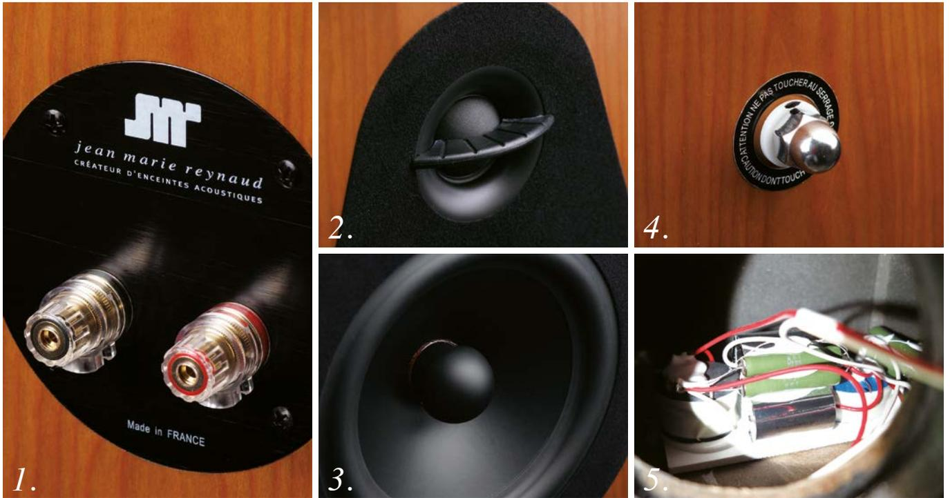
▲圖1. WBT喇叭端鎖在鋁板上再予以固定，可抑止端子震動提升音質。 圖2. 絲質的凸盆高音利用小號角提升效率，也順便控制指向性，水平隔板的作用是控制相位。 圖3. JMR特別注重低音的力度與規模感，所以低音單體都有較寬的懸邊與長衝程的特性，單體中央的球狀物是固定的相位錐，讓中音有均勻的擴散性。 圖4. 音箱背後的螺帽不可轉動，因為這是低音單體支撐桿的端子。 圖5. 分音器採用法國製SCR銀質電容器，以此價位的產品來說是下重本。
