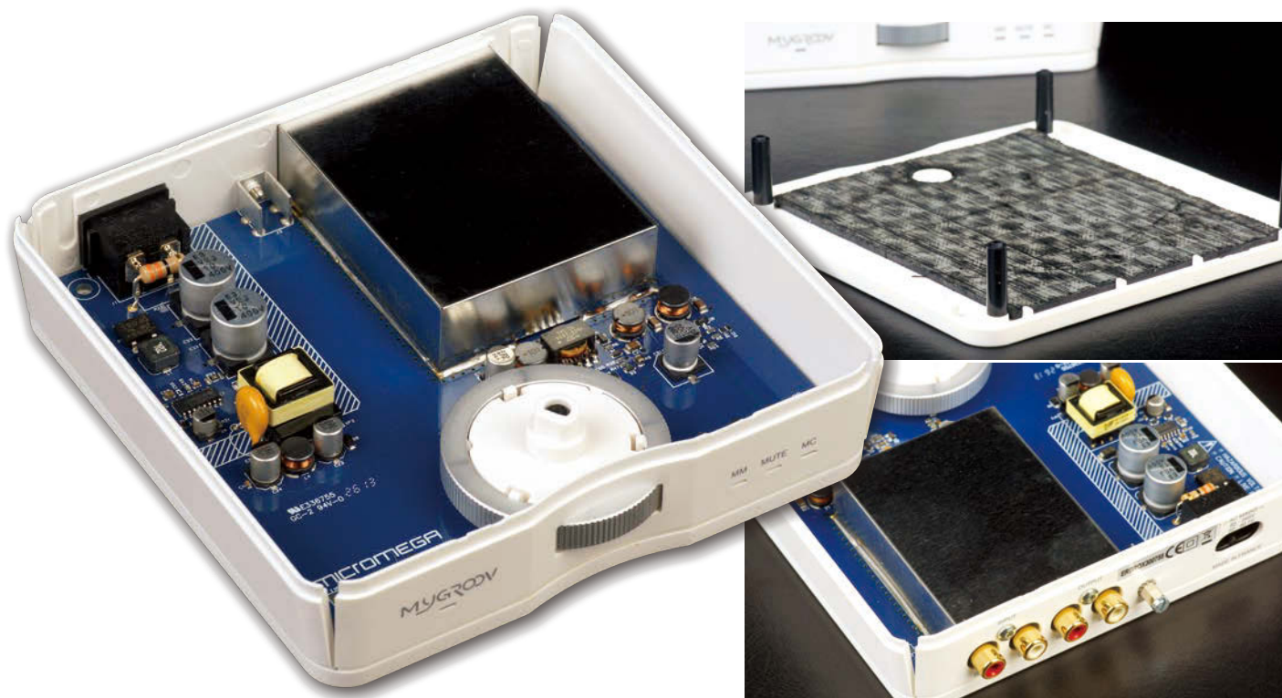
▲右上：訊號輸入與放大輸出電路全被一鋁板覆蓋且完全焊死，可防堵外界射頻等噪訊干擾，同時，也防止讓其他廠家、玩家抄襲其電路架構。 右下：頂蓋處黏有一大片的吸震瀝青片，可有效吸收ABS塑鋼機殼的共振，使聲底更趨於寧靜致遠。
