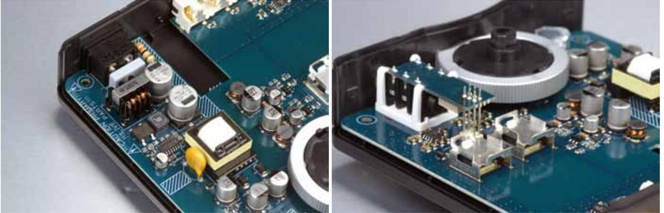
▲左：MyZic是以高頻變壓器等組件處理電源，電路板上接地面積相當大，徹底避免電源部與訊號部間的不當感染。 右：Neutrik耳機插座後為本機輸出電路，採晶體管作放大，增益達12dB，難怪趨動力會比多數採用OP放大架構的耳擴來得更有餘裕。
