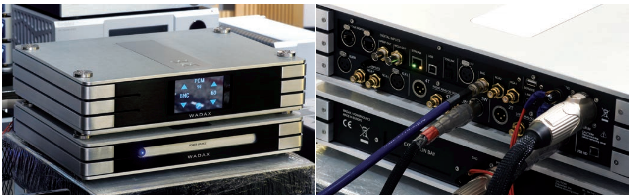
▲左：Pre 1 Ultimate採電源分離式，雙鋁合金機箱設計。若再加入另一部可作CD轉檔與音樂串流伺服器之用的「Hermes Server」，就成了三件式的Wadax Trio。 右：Pre 1U擁有數位前級、ADC、DAC、USB DAC與有線網路的Net DAC等多源機能，背板端子當然就會如此密密麻麻，應有盡有。
