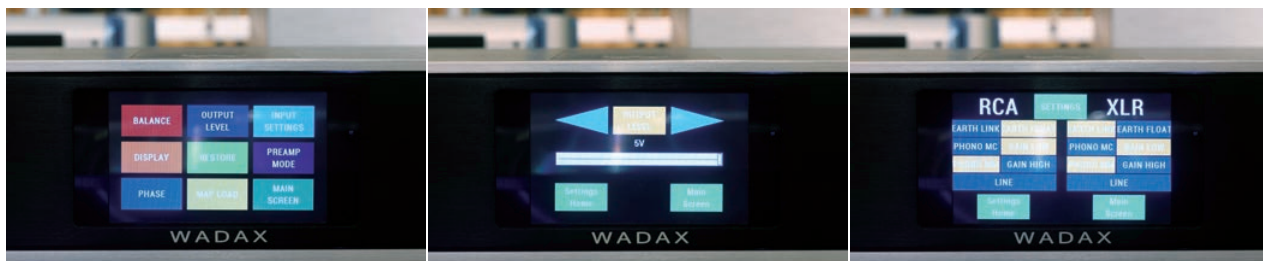
▲左：本機提供左右聲道平衡、輸出電平(最高5V)、輸入設定、螢幕顯示、前級設定、相位、唱放、回到主選單與回溯出廠值等九大設計功能。 中：輸出電平最高可設定為5V。若府上後級並不輸要這個高電壓輸入，則可調為2V或更低，藉以達成前後級的完美匹配。右：若要使用本機的唱放功能，除需額外購買NanoVolt唱放大模組外，還要在輸入選擇中設定MM或MC，低增益或高增益與接地狀態。
